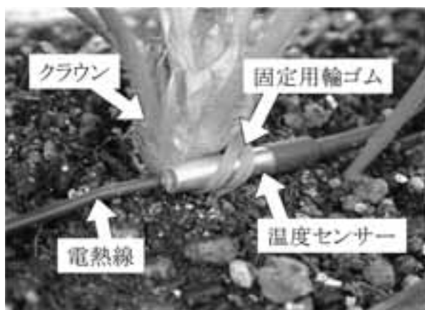
第1図 電熱線および温度センサーの設置状況
